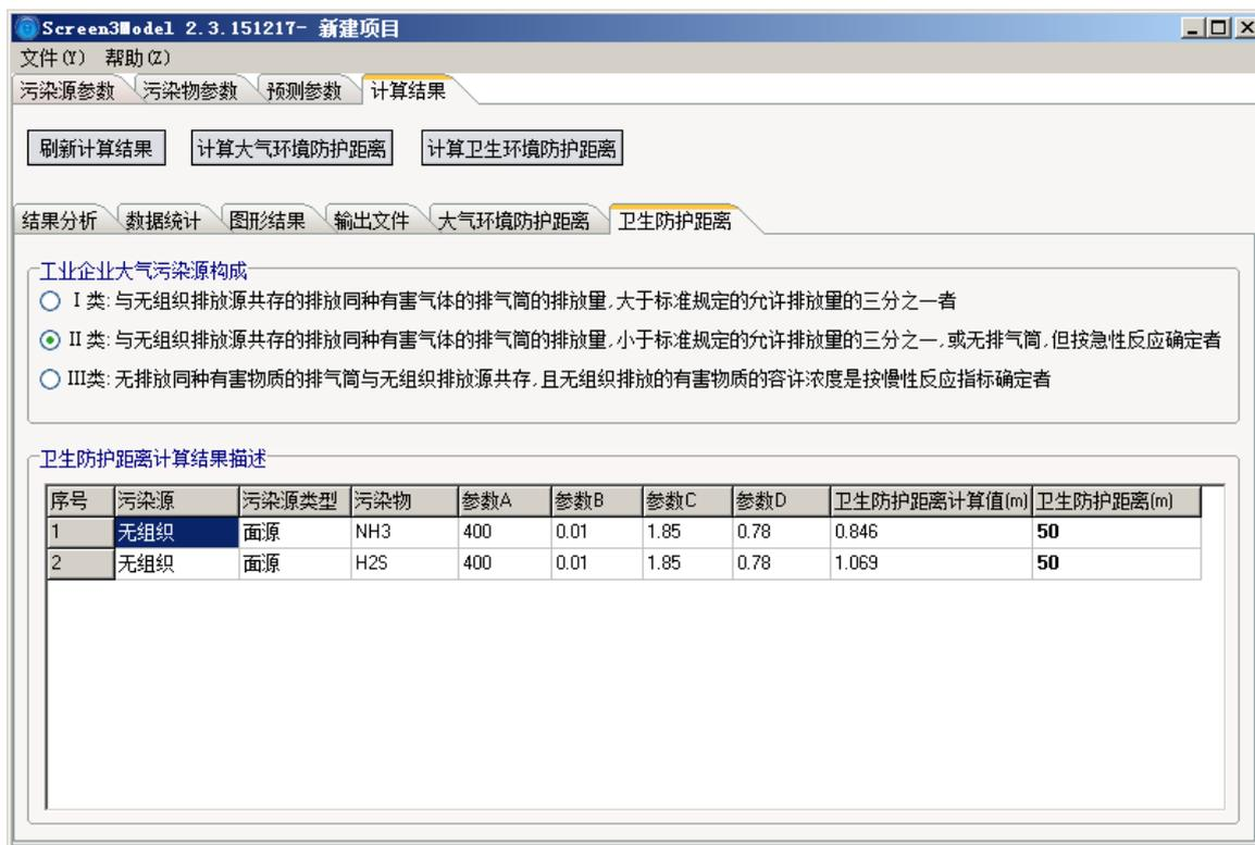
图 6-2 无组织面源卫生防护距离计算结果
